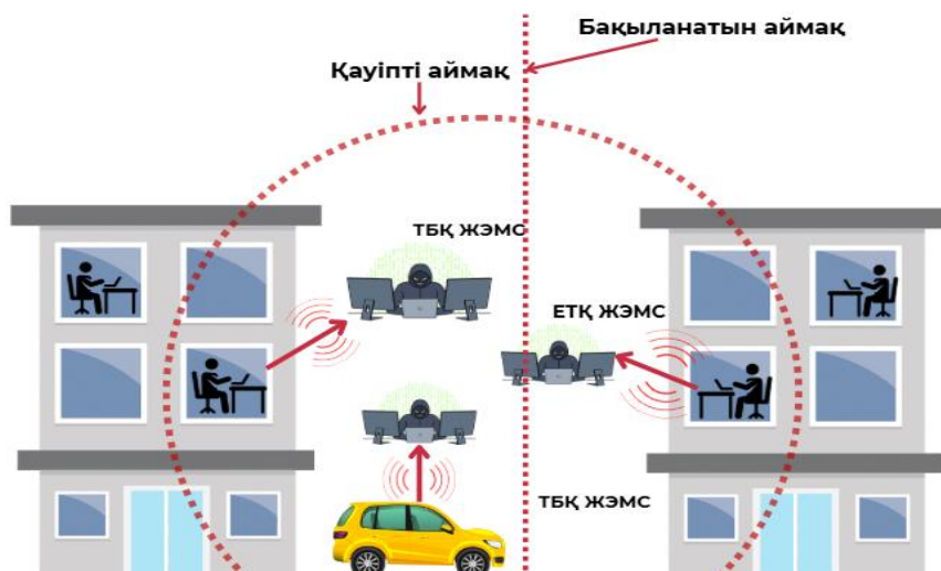
Сурет 1. Есептеу техникасы құралдарының (ЕТҚ) жанама электромагниттік сәулеленулерін (ЖЭМС) техникалық барлау құралдарымен (ТБҚ) ұстап алу схемасы
