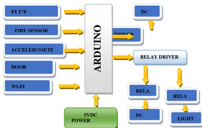
Сурет 1. Эксперименттің құрылымдық схемасы
